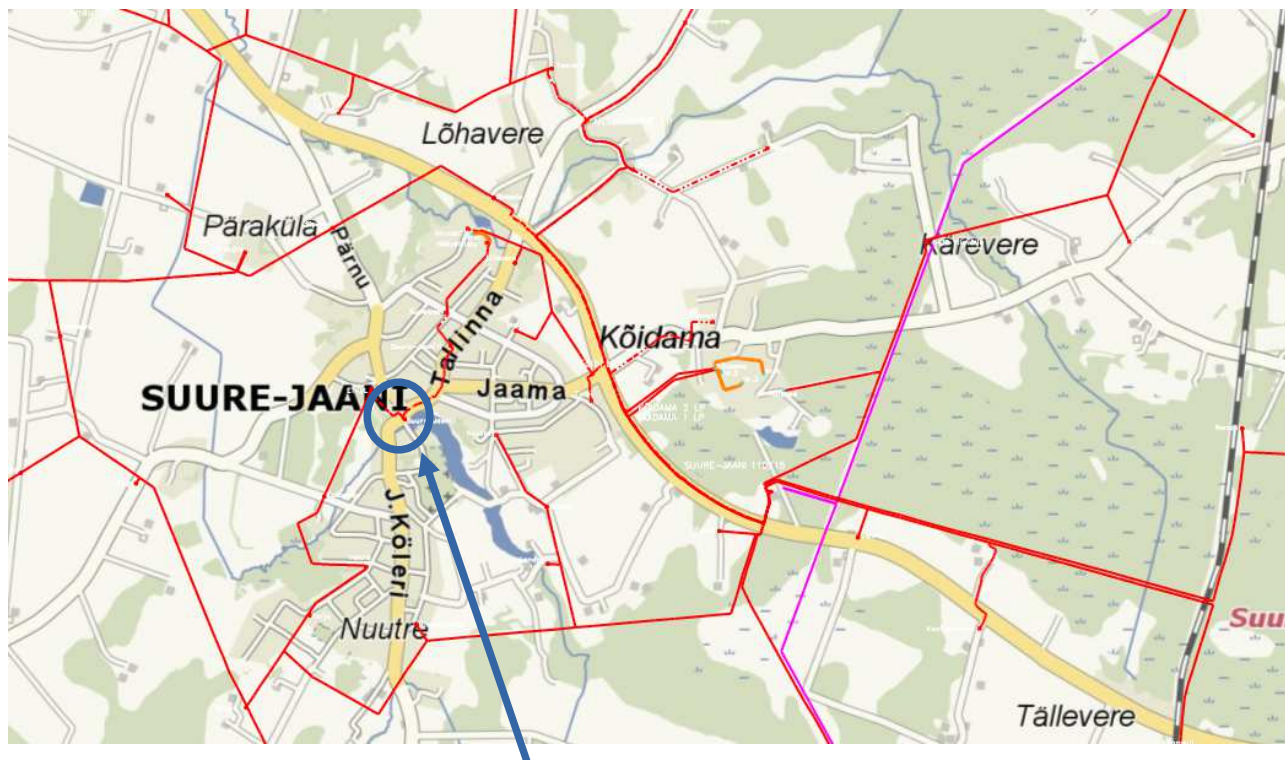
Joonis 1.1. Projekteeritud komplektalajaam, 15 ja 0,4 kV maakaabelliinid, jaotus- ja liitumiskapid ning 0,4 kV õhuliin
